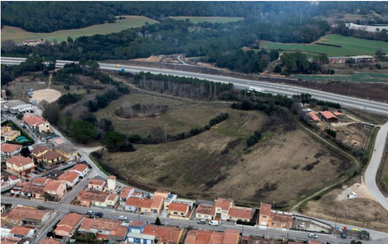
Figura A4-12. Registre morfològic d'activitat d'enfonsament per presència de guixos al subsol. S'observa la forma circular de la dolina principal i d'una petita dolina central on hi ha un estany. Camp de l'Estany (Besalú, Pla de l'Estany). Font: Ivan Fabregat.
