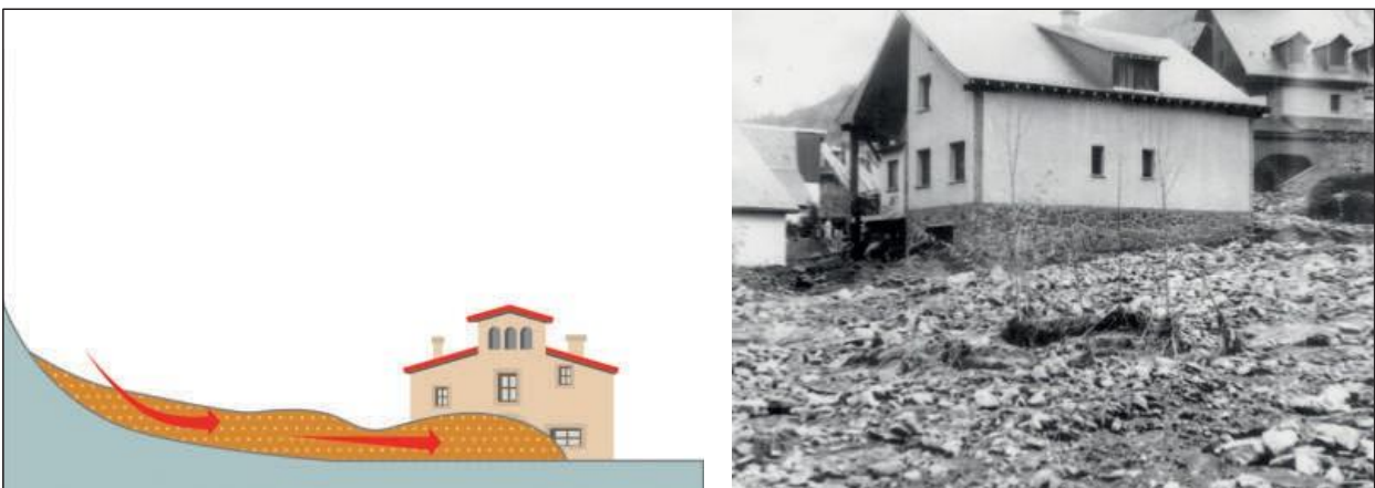
Figura 4. Tall esquemàtic representatiu d'un flux. Fotografia: Dipòsit d'un flux de tipus corrent d'arrossegalls al voltant de les cases del Carrer dera Capella de Vielha, ocorregut el 6 de novembre de 1982. Font: Ajuntament de Vielha e Mijaran, Escuer (2013).
