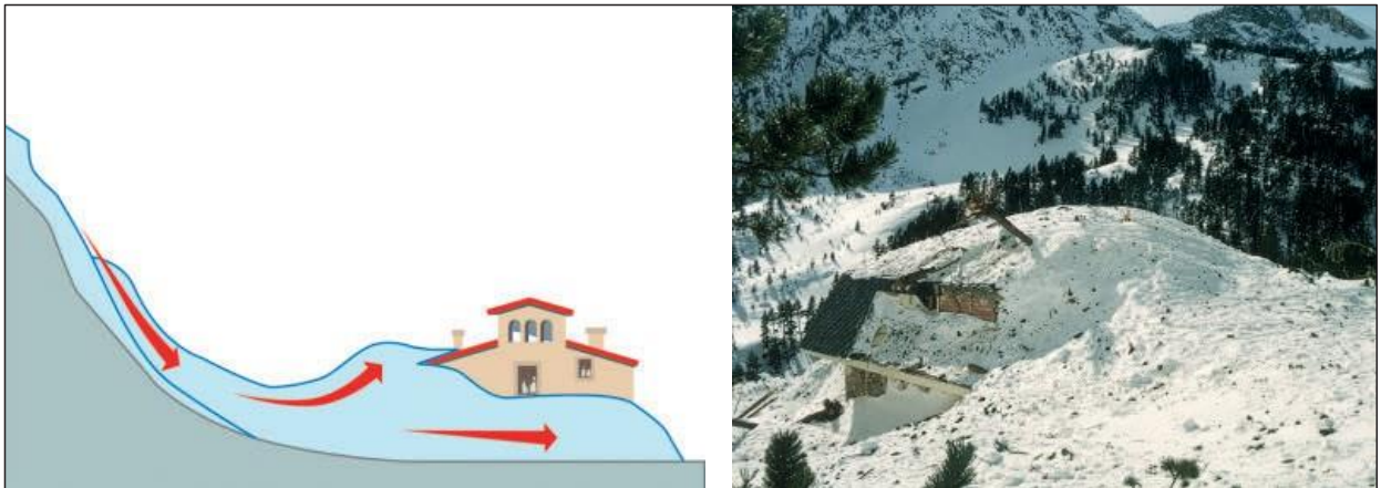
Figura 6. Tall esquemàtic representatiu d'una allau de neu. Fotografia: Impacte i dipòsit d'una allau sobre el refugi de Pastuira el 8 de febrer de 1996. Font: ICGC.
