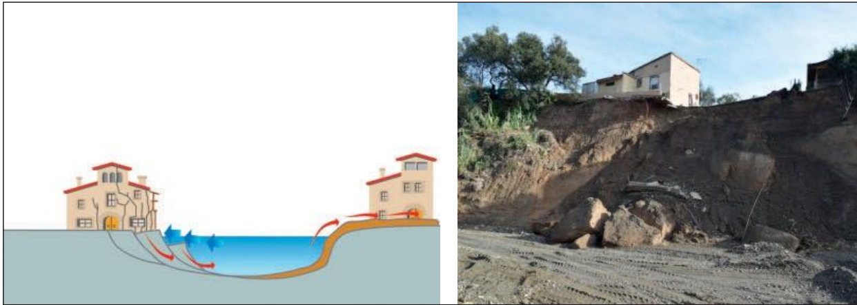
Figura 8. Tall esquemàtic de l'erosió i deposició provocat per un corrent fluvial. Fotografia: Lliscament ocorregut el 23 d'octubre de 2019, conseqüència del soscavament de la Riera de Gaia a Sant Miquel de Gonteres (Viladecavalls). Font: ICGC.
