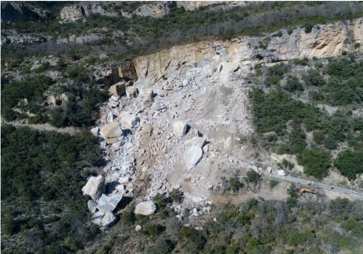
Figura A1-5. Despreniment massiu (mida M5) provocat pel desplom d'una cornisa a la carretera LV-9124, al terme de Guàrdia de Noguera, el 16 d'abril de 2018. Font: ICGC.
