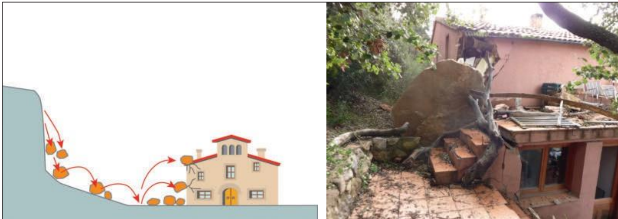
Figura 2. Tall esquemàtic representatiu d'una caiguda de roques. Fotografia: Impacte d'un bloc caigut en un habitatge de la Clua (Artesa de Segre) el 24 de desembre de 2009. Font: ICGC.
